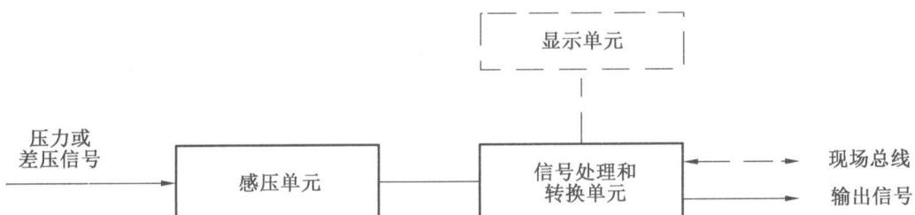
图 1 压力变送器原理框图
