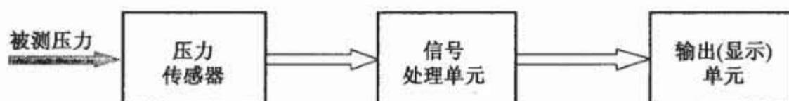
图 1 气压计工作原理
